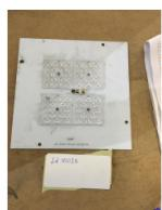
[-] PCB con Lente Asimétrica SMD3030 para Aventino/Arrow 40W (Módulo LED)
